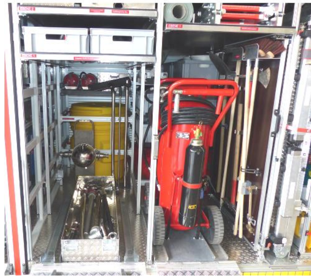
Bergungsfass, Handpumpe, Pulverlöscher
