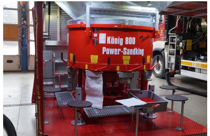
Sandsackfüllanlage mit 7 Abfüllplätzen
