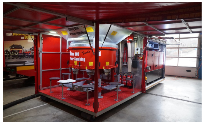
Abfüllanlage mit Wetterschutz
