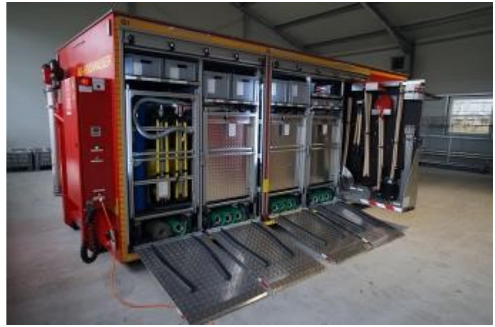
Rollcontainer Beleuchtung + Pumpen, Werkzeugwand
